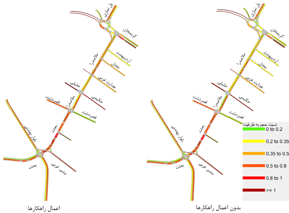
شکل ۶-۷۶: تحلیل عملکرد و خدمت دهی مقطع ۷ برای افق ۱۴۰۹ (نمودار نسبت حجم به ظرفیت)
