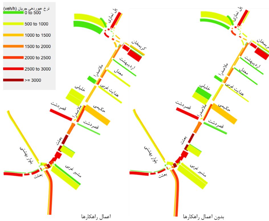
شکل ۶-۶۹: تحلیل عملکرد و خدمت دهی مقطع ۷ برای افق ۱۴۰۹ (نمودار نرخ عبوردهی جریان)
