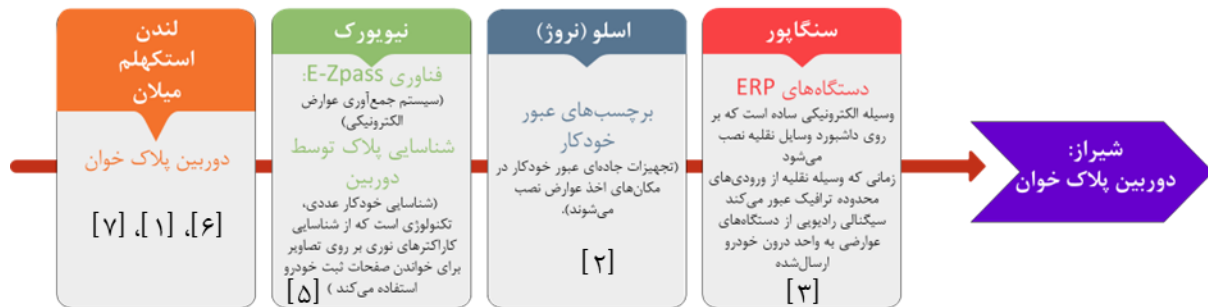
شکل ۴-۳: انواع تجهیزات پایش تردد
